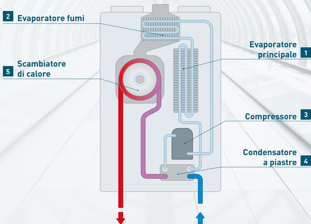
L'EFFICIENZA È COSÌ ELEVATA CHE I FUMI DELLA COMBUSTIONE ESCONO ALLA TEMPERATURA DI 10°C CIRCA
